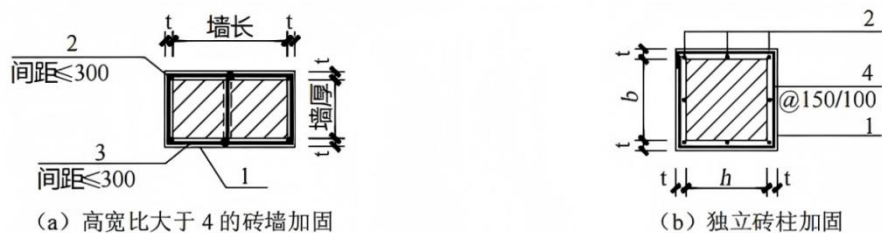
图 6.3.4 独立砖柱或高宽比大于 4 的砖墙加固做法
